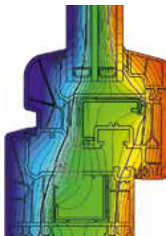
Isothermenverloop Schüco LivIng Rondo met middendichting Tracé des isothermes Schüco LivIng Rondo avec joint central
